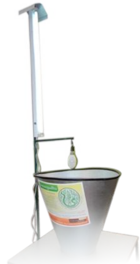
กับดักแสงไฟพร้อมพัดลมดูด เพลี้ยกระโดดสีน้ำตาล
